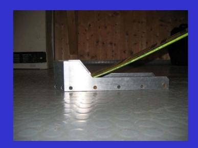
Die **Seitenformbreite** wird **elektronisch vermessen**. Der Mindestabstand der Skispitze zum Boden beträgt 30 mm. Kontur des Skiendes maximale Höhe 10 mm.
